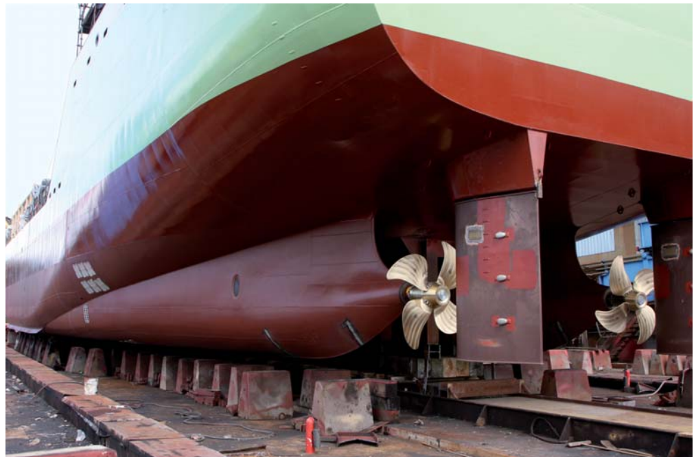
Anordnung des Propulsionssystems mit zwei vierflügligen Propellern und nachfolgend angeordneten Rudern
